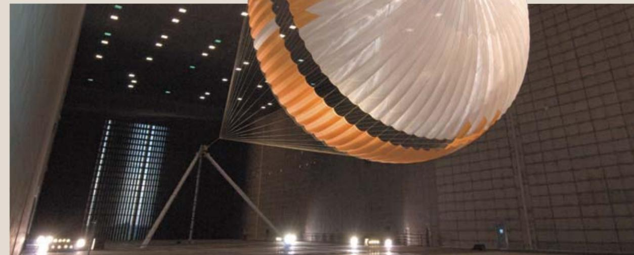
火星探査機「キュリオシティ」の着陸用パラシュートの風洞実験の様子。パラシュートと探査機を結ぶサスペンション・コードに、帝人が開発したアラミド繊維の「テクノーラ」が採用された（写真提供=NASA/JPL-Caltech）
