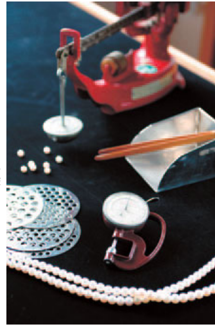
直径を測るゲージや、粒の大きさごとに選り分けるための穴のあいた板「フルイ」など、真珠の選別に使われる道具
