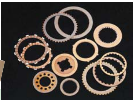
左／ダイナックスが開発したペーパー摩擦材（下）を接着したディスク。クラッチの機能を助ける 右／自動変速機内部では、鉄のディスクを擦り付けたり離したりして変速する
