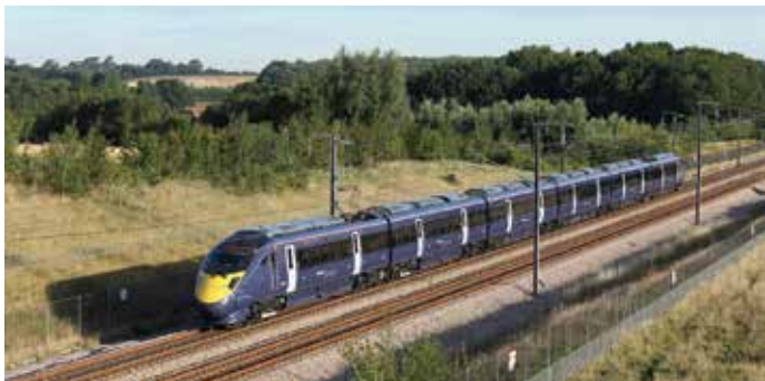
ロンドンと英仏海峡トンネルを結ぶ高速新線を走る日本製車両。在来線と高速専用線の両方を自在に走れる
