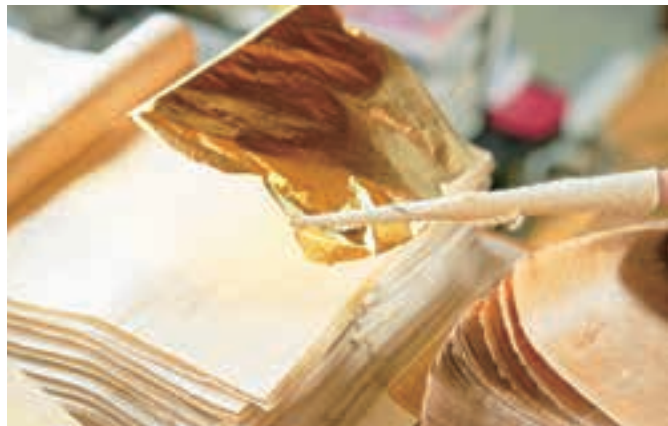
向こうが透けて見えるほどの薄さに打ちのばされた金箔は、職人の長年の経験と技が不可欠
