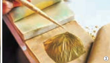
3. 別の箔打紙に移し替えて、再び機械で打ちのばす
