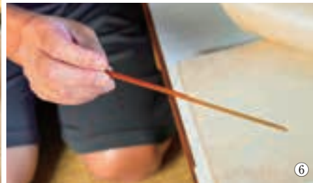
6. 触ると崩れやすい繊細な金箔には、静電気に影響されない竹製の専用の道具が使われる
