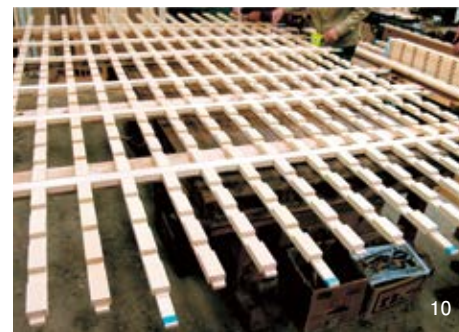
8／約800年前に建立された大報恩寺に取り付けられた部戸（しとみど。写真左手）と呼ばれる建具（写真＝アフロ） 9／木組をする建具職人の鈴木正さん。伝統建具の製作や修理に60年以上携わってきた第一人者で、近年は技術継承にも力を注ぐ（写真提供＝全国伝統建具技術保存会） 10／格子に板をはさんだ部戸の製作風景。格子の木組には、寸分の狂いも許されない（写真提供＝全国伝統建具技術保存会）
