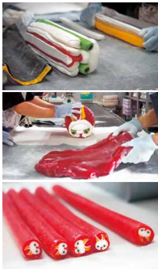
細長く引き伸ばした組み飴のパーツを組み上げ(上)、円筒状にまとめ(中)、2cmの細さに引き伸ばしていく(下) (写真提供=まいあめ) 左／「ありがとう」を表した日本語と英語の組み飴
